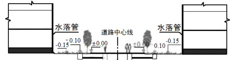
屋面雨水 → 水落管 → 下凹绿地 → 超渗雨水 → 雨水口 → 雨水管道 → 排除
