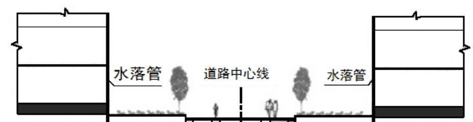
屋面雨水 → 水落管 → 明沟或检查井 → 雨水管道 → 排除
