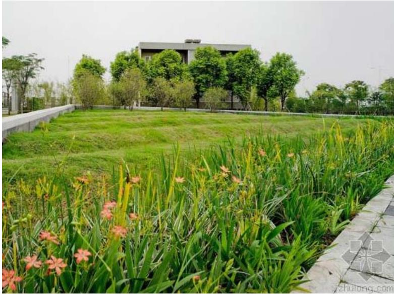
图 7-57 道路雨水可就近排入外侧绿地
