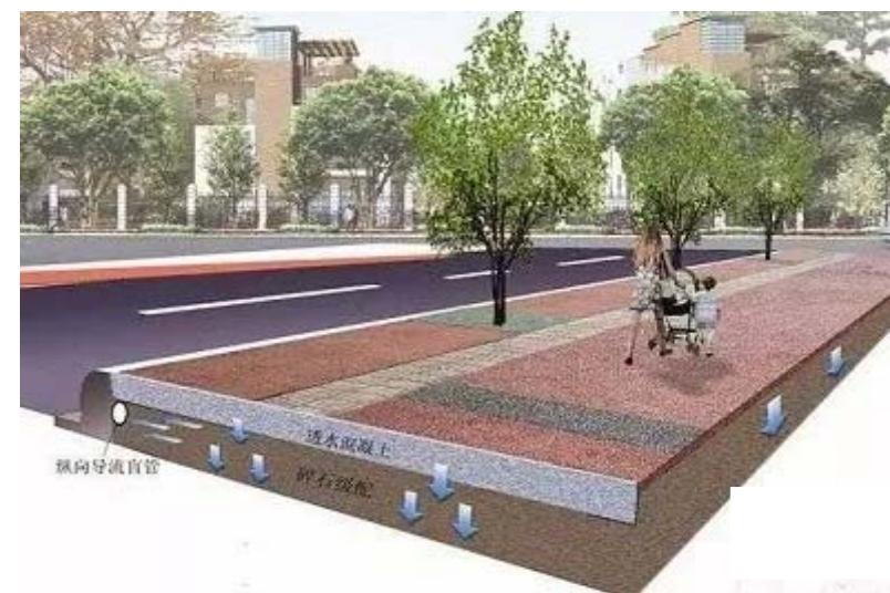
图 8-28 人行道、非机动车道透水铺装示意图
